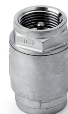
SPRING CHECK VALVE (PTFE-FKM) VALVOLA DI RITEGNO A MOLLA (PTFE-FKM) PN16 3/8" - 2"
